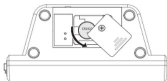
3. Enlevez et recyclez la batterie vide. Remplacez-la par une nouvelle pile de type bouton 3 V, CR2032 au lithium
