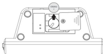
4. Refermez le panneau du compartiment à pile et serrez la vis afin de le sécuriser en place
